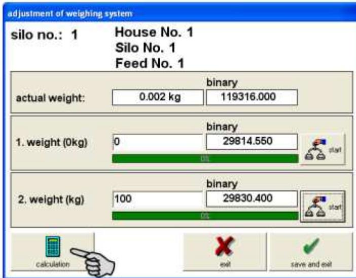
10. 完成称重系统校准，点击“保存和退出”确认校准结果。
