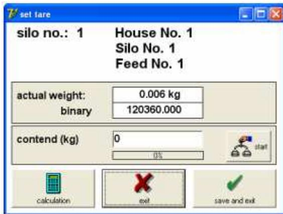
5. 如果料塔内无料，在“饲料重量(千克)”框中输入“0”。如果料塔内有料并知道当前的饲料重量，则把此重量输入“实际重量”框中。
