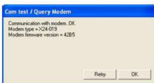
以此检查与无线模块之间的连接，结果显示在屏幕上。
