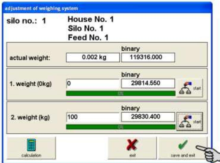
如果您不想接受此次校准结果，点击“退出”即可。如果点击“退出”，称重系统将恢复到没有被校准的状态！
